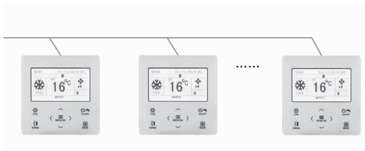
Schemat instalacji komunikacji bramka BACnet - sterowniki XK76
