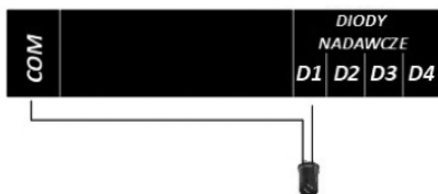
Diody D2 – D4 podłączamy analogicznie
