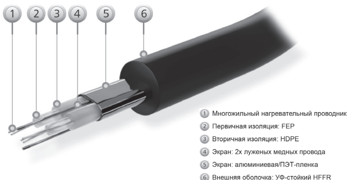
Конструкция кабеля нагревательного мата ELEKTRA SnowTec® Tuff
