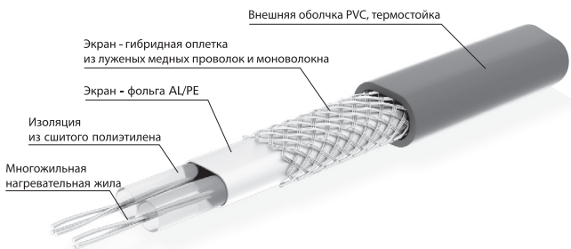
Конструкция нагревательного мата ELEKTRA SnowTec®
