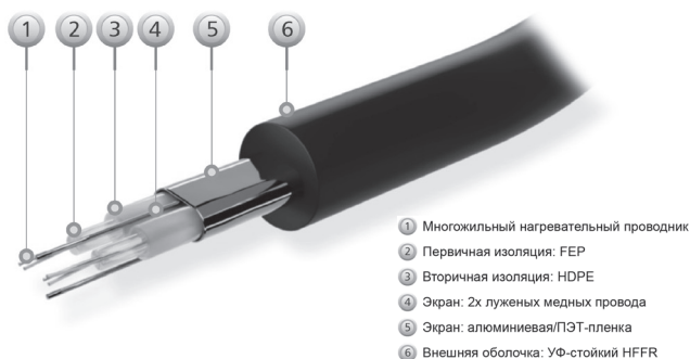
Конструкция нагревательного кабеля ELEKTRA TuffTec™
