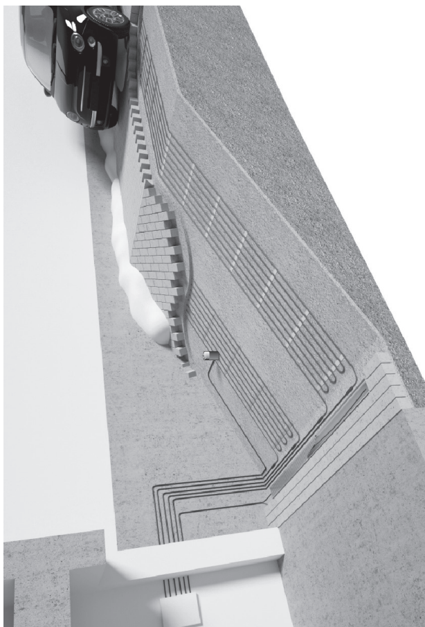
Przykład ułożenia przewodów grzewczych ELEKTRA VCD25 w podjeździe do garażu wykonanego z kostki brukowej
